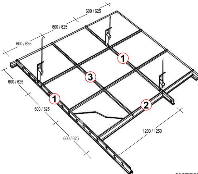
Il sistema MICRO 8 CPM a vista, è costituito dal profilo portante da mm 3600 e da intermedi da mm 1200 e mm 600 aventi un aggancio in semplice appoggio. La dimensione di tutto il sistema è di mm 15 x 38.
