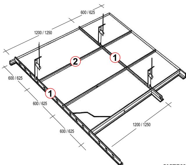
Il sistema MICRO 8 CPM DIN a vista, è costituito dal profilo portante da mm 3750 e da intermedi da mm 1250 e mm 625 aventi un aggancio con sormonto e scatto. La dimensione di tutto il sistema è di mm 15 x 38.
