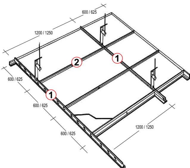
Il sistema 8 CPA DIN a vista, è costituito dal profilo portante da mm 3750 e da intermedi da mm 1250 e mm 625 aventi un aggancio in semplice appoggio entrambi con una dimensione di mm 24 x 38.
